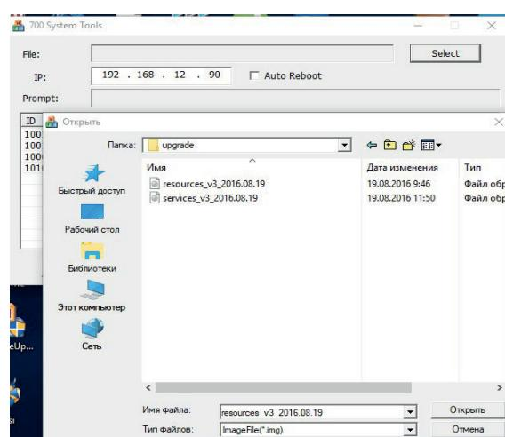
4. В списке оборудования выберите устройство (по его IP-адресу или логическому номеру), на котором необходимо обновить прошивку и нажмите кнопку “Upgrade”. После удачной загрузки файла программа напишет “Success”.
